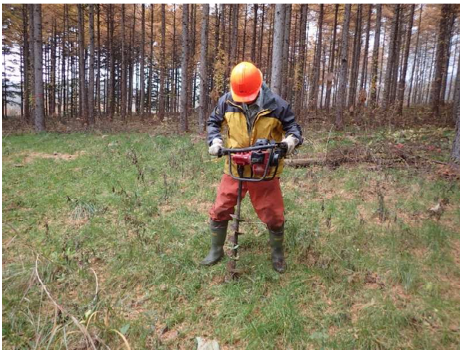
神遊の桜 アースオーガによる縦穴掘り 2021.11.08 (高野亮三氏撮影)
