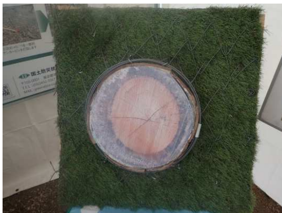
ウッズネット工法の模型、 リング部分のワイヤーが樹木の成長とともに伸びる
