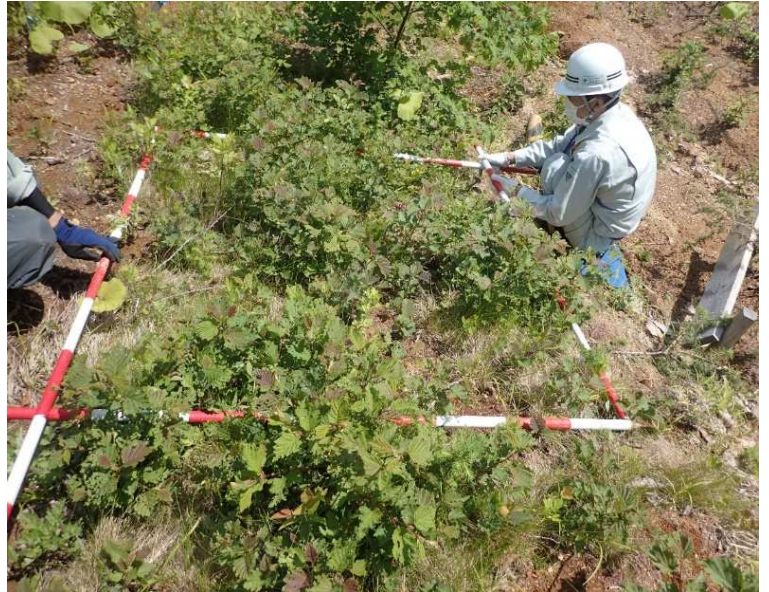
「ECO バインド Air 工法」の厚真町試験地の事例（スラリー手播き） 2成長期を迎えた2021年6月8日の状況
