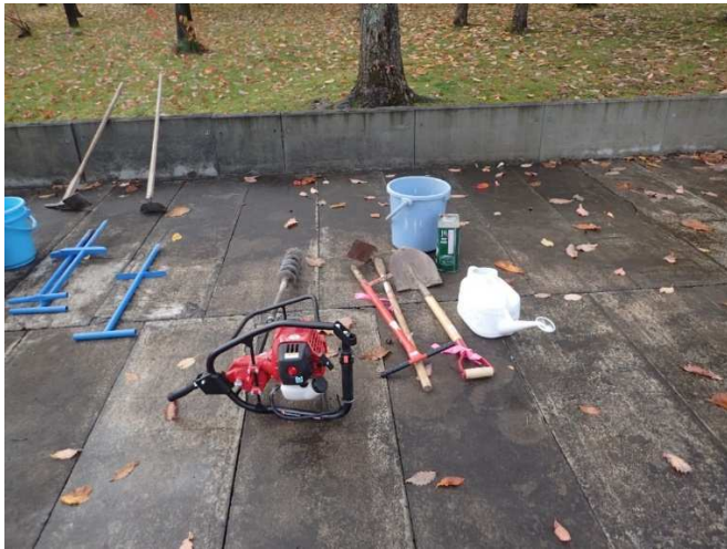
縦穴の掘削に使用したアースオーガなど
