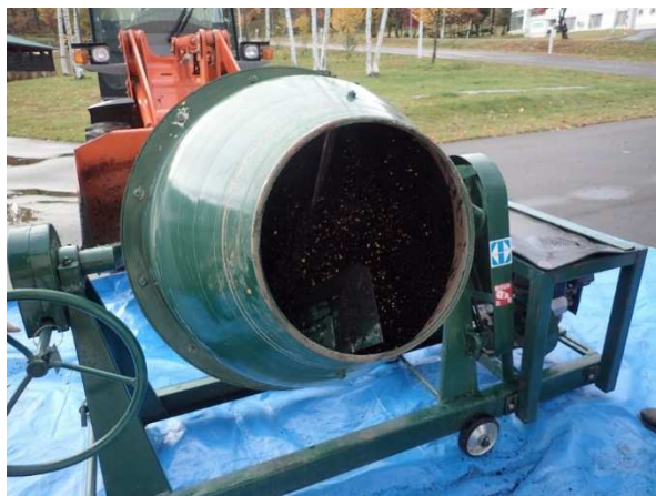
現場練りコンクリートミキサーとトラクタショベル
